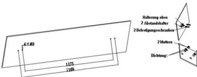
1. Als ersten empfehlen wir 4 Bohrungen mit einem Durchmesser von 9mm in der Decke nach Zeichnung oben anzubringen
