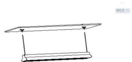
3. Die Aufhänger an der Leuchte befestigen und in die Halterungen an der Decke einhängen
